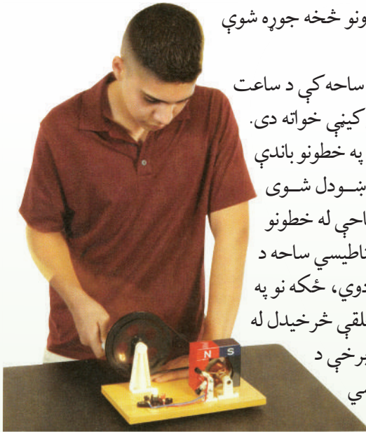
(9-18) شکل: په یو ساده جزراتور کې، په مقناطیسي ساحه کې د هادي حلقو څرخیدل، په حلقو کې د برېښنا متناوب بهیر تولیدوي.
